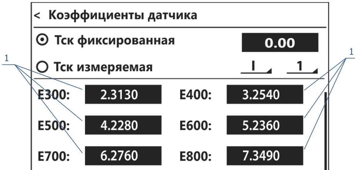
Рисунок 15 — Ввод параметров эталонных ТП
